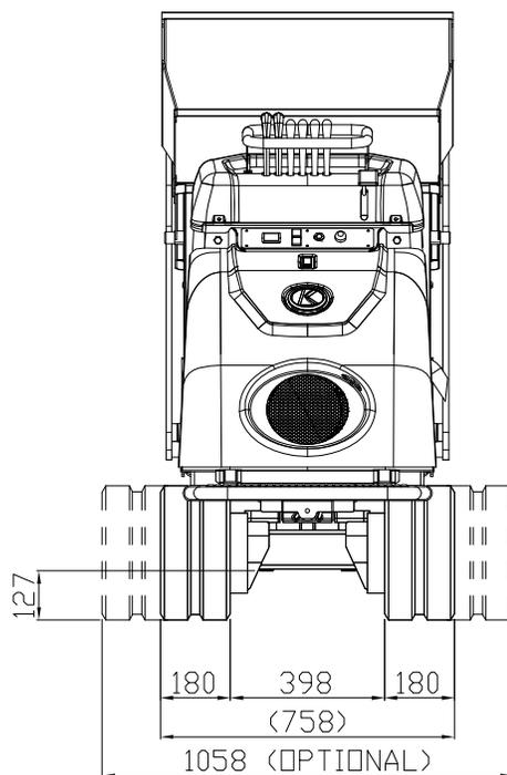
Dimensjoner og mål som gjengis i denne tegningen er nominelle. Faktiske verdier kan avhenge av robustheten i enkeltkomponenter, slark i koblinger og forbindelser, deformasjon i elastiske deler osv.
